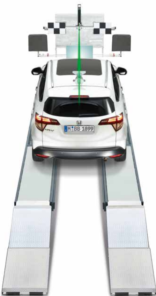
Honda HRV mit BBFAS 1000 mit Nachrüstsatz BBFAS 1415 Kalibriertafel Honda Typ 1
