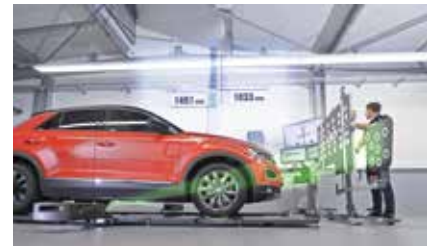
Ausrichtung des FAS-Kalibriersystems
