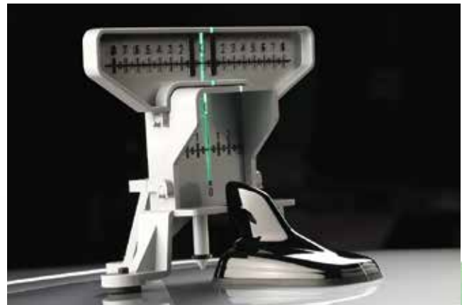
Zieltafel für Dachantennen bei Ausrichtung zur Fahrzeugsymmetrieachse (Bestellnummer: 8 900 381 292)
