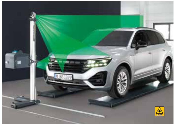
Digitale Scheinwerfereinstellung mit 4 Lasern
