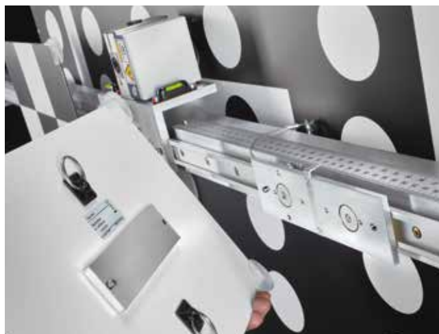
Befestigung der Kalibriertafeln mit Hilfe von Magnetadaptern an der Schiebekulisse des Präzisionsbalkens BBFAS 1415
