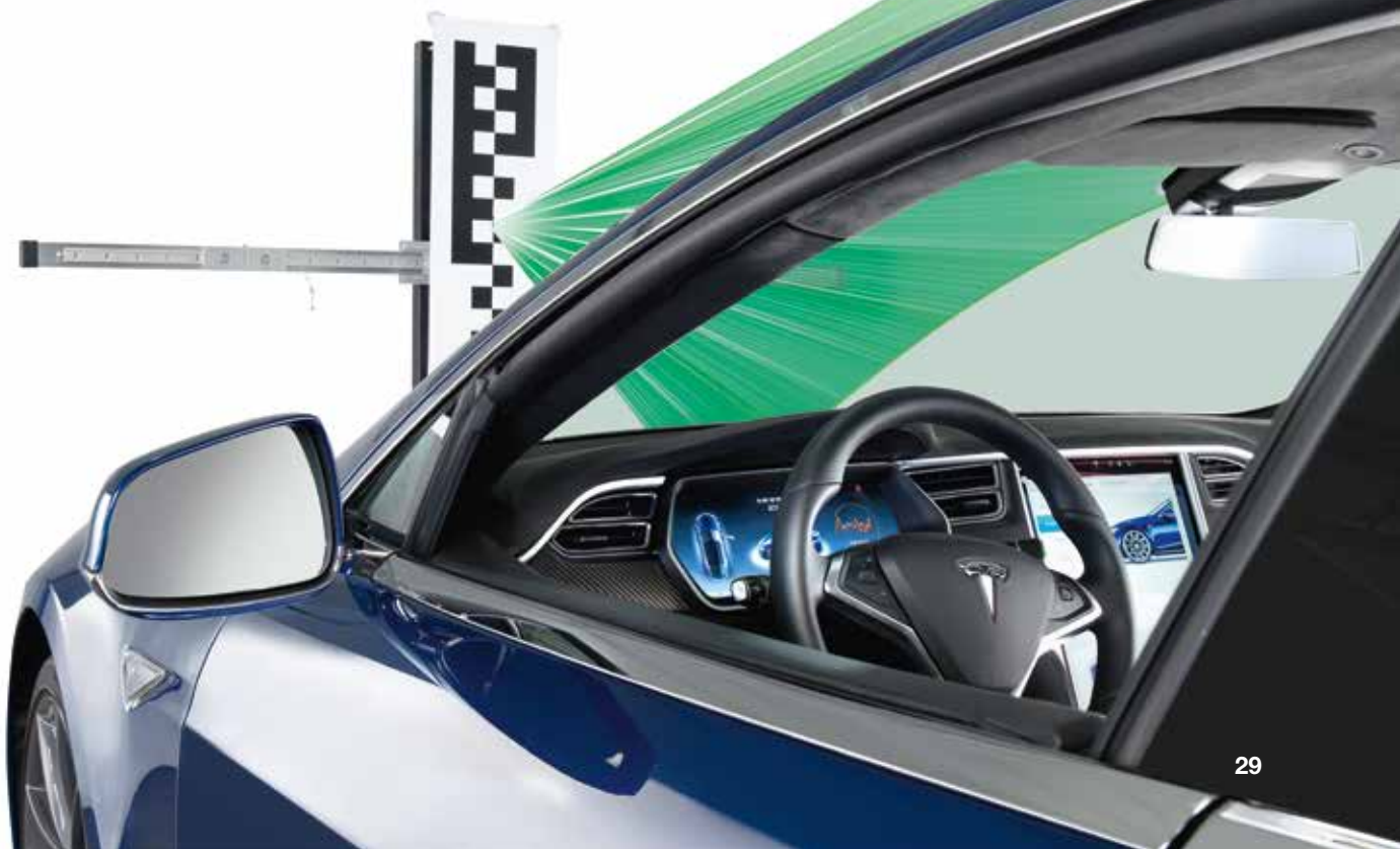
Zieltafel für Dachantennen bei Ausrichtung zur Fahrzeugsymmetrieachse (Bestellnummer: 8 900 381 292)
